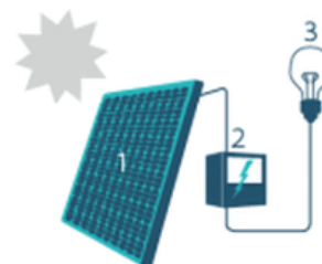
1. Zonnepaneel | 2. Omvormer | 3. Elektrische toestellen
